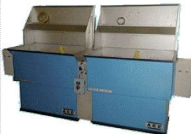
冷浸或热浸清洗池
